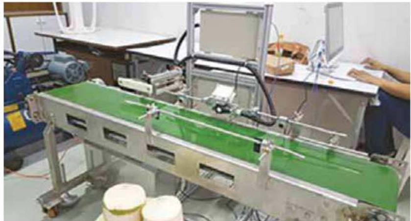
เครื่องอินฟราเรดตรวจสอบคุณภาพมะพร้าวน้ำหอมที่จะประยุกต์ใช้ตรวจความอ่อนแก่ของผลทุเรียน
