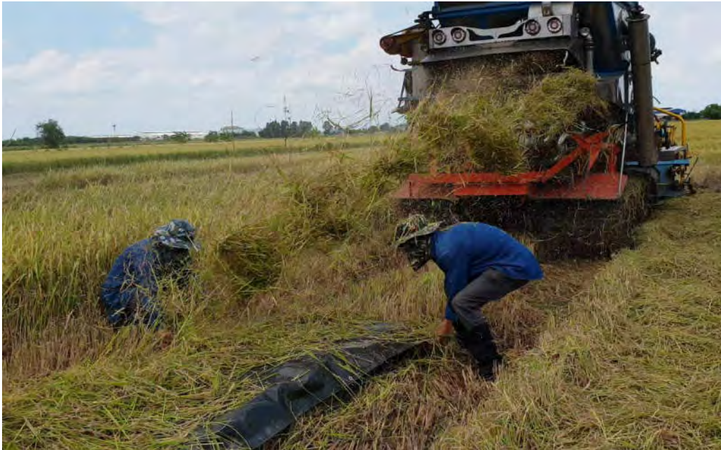
ภาพที่ 4.21 การเก็บตัวอย่างการสูญเสียที่เกิดขึ้นจากบริเวณห้องลูกนวดและชุดตะแกรงทำความสะอาด
