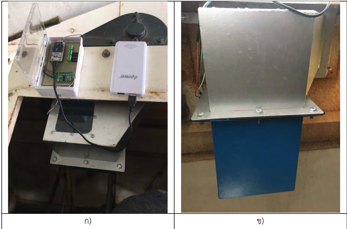
ภาพที่ 4.5 การติดตั้งอุปกรณ์วัดปริมาณผลผลิตข้าวเปลือกเข้ากับรถเกี่ยวขนาดข้าว
