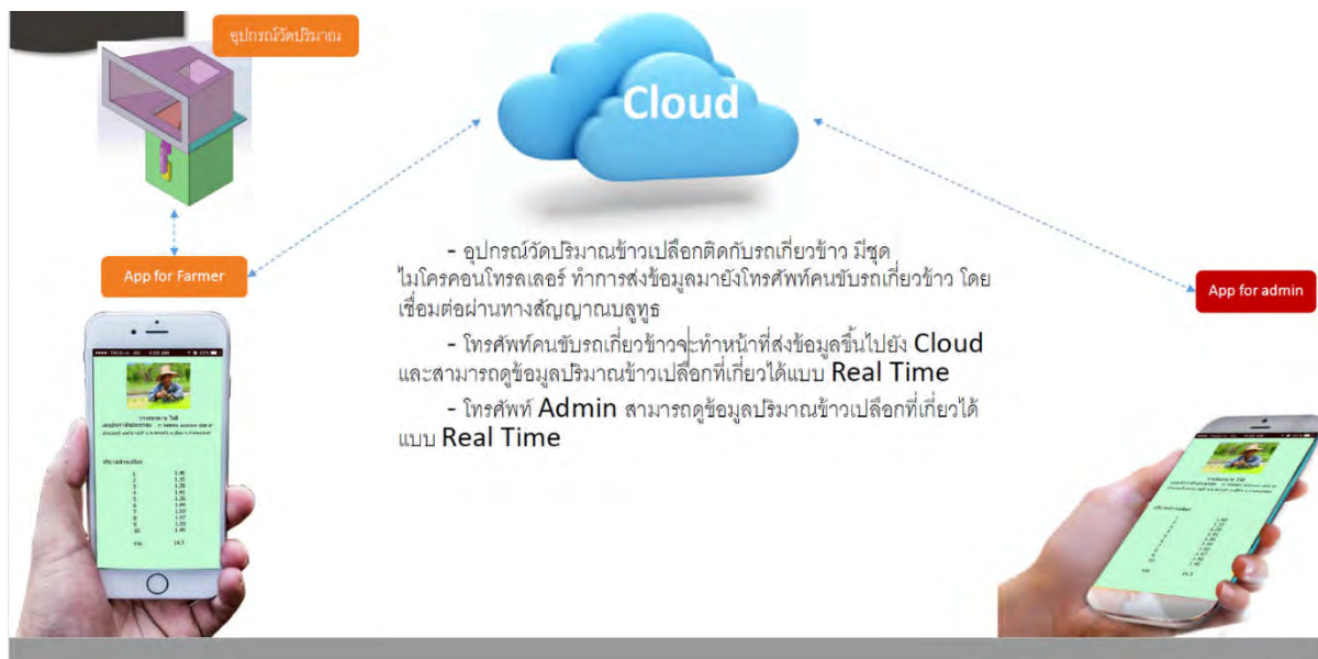
ภาพที่ 4.6 การส่งข้อมูลปริมาณผลผลิตข้าวเปลือกที่เกี่ยวข้องขนาดได้ผ่านทางสัญญาณบลูทูธ
