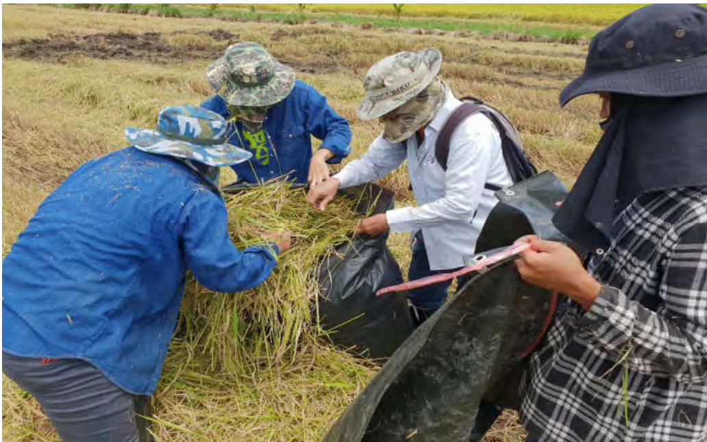
ภาพที่ 4.22 การรวบรวมตัวอย่างการสูญเสียที่เกิดขึ้นจากบริเวณห้องลูกนวดและชุดตะแกรงทำความสะอาด
