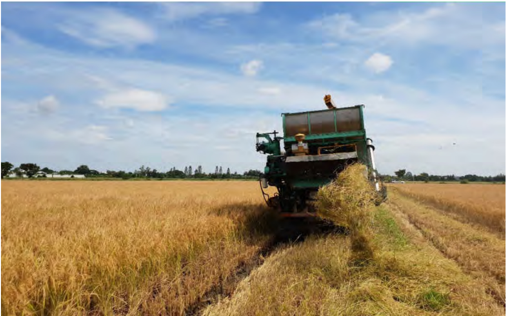
ภาพที่ 4.20 การสูญเสียที่เกิดขึ้นจากบริเวณห้องถูกนวดและชุดตะแกรงทำความสะอาด
