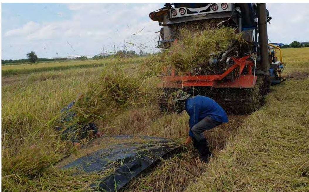
ภาพที่ 2.3 การทดสอบหาปริมาณการสูญเสียที่เกิดขึ้นจากชุดลูกนวดและชุดทำความสะอาด
