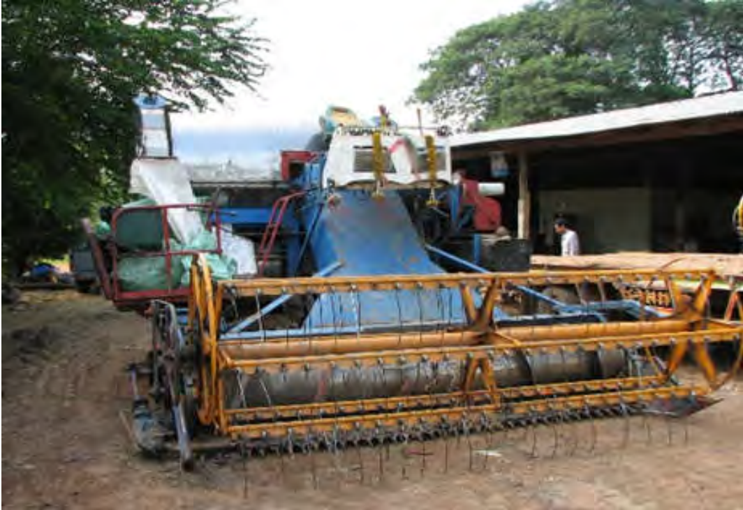
ภาพที่ 3.2 รถเกี่ยวนวดข้าวแบบที่มีการเก็บบรรจุลงกระสอบ
