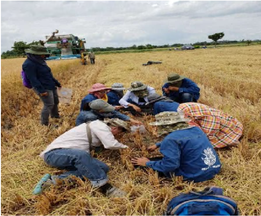
ภาพที่ 2.4 การทดสอบหาปริมาณเมล็ดข้าวเปลือกที่ร่วงหล่นอยู่บริเวณด้านล่างของแผ่นผ้าใบ
