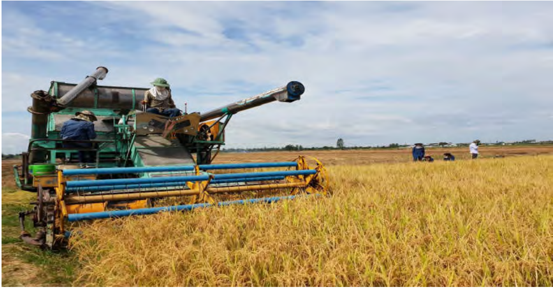
ภาพที่ 4.17 รถเกี่ยวรวงข้าวแบบไทยประดิษฐ์ที่ใช้ในการทดสอบที่ จังหวัดสุพรรณบุรี
