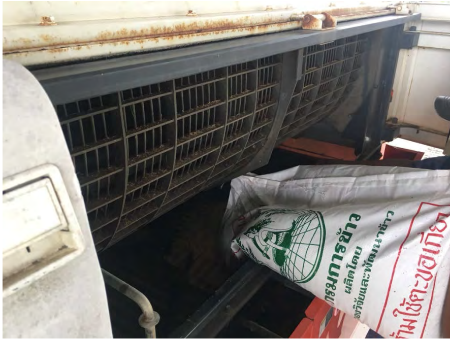
ภาพที่ 4.12 การนำข้าวเปลือกที่ซังน้ำหนักแล้ว มาเทใส่ลงในห้องลูกนวด
