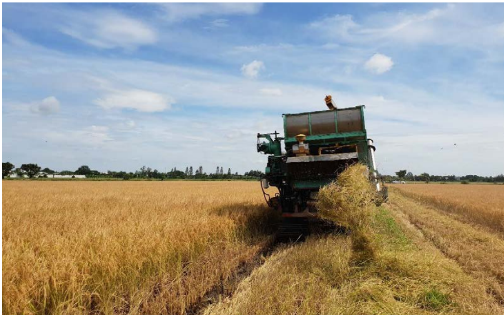
ภาพที่ 4.20 การสูญเสียที่เกิดขึ้นจากบริเวณห้องลูกนวดและชุดตะแกรงทำความสะอาด
