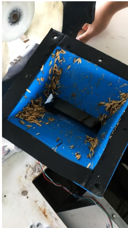
ภาพที่ 4.13 เมล็ดข้าวเปลือกที่ไหลผ่านชุดอุปกรณ์เซนเซอร์วัดปริมาณเมล็ดข้าวเปลือก
