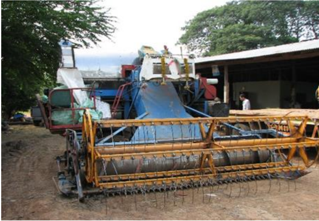
ภาพที่ 3.2 รถเกี่ยวนวดข้าวแบบที่มีการเก็บบรรจุลงกระสอบ
