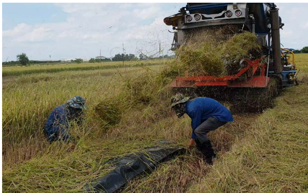
ภาพที่ 4.21 การเก็บตัวอย่างการสูญเสียที่เกิดขึ้นจากบริเวณห้องถูกนวดและชุดตะแกรงทำความสะอาด
