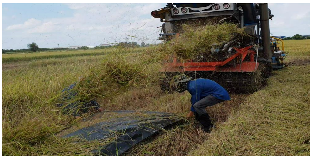
ภาพที่ 2.3 การทดสอบหาปริมาณการสูญเสียที่เกิดขึ้นจากชุดลูกกวาดและชุดทำความสะอาด
