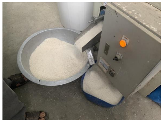
ภาพที่ 4.11 เครื่องสีข้าวขนาดเล็กที่เกษตรกรปรับปรุงเป็นเครื่องคัดแยกสิ่งเจือปน
