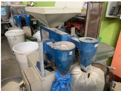
ภาพที่ 4.11 เครื่องสีข้าวขนาดเล็กที่เกษตรกรปรับปรุงเป็นเครื่องคัดแยกสิ่งเจือปน
